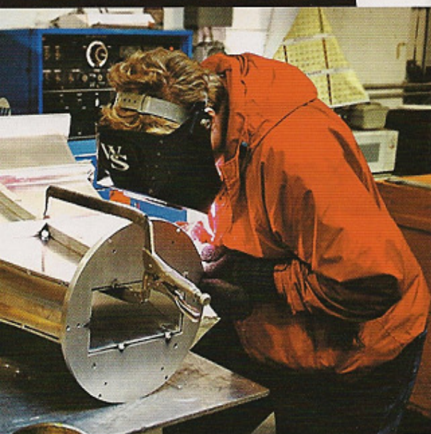
每隻中低音 Horn 喇都要以人手燒焊而成。
