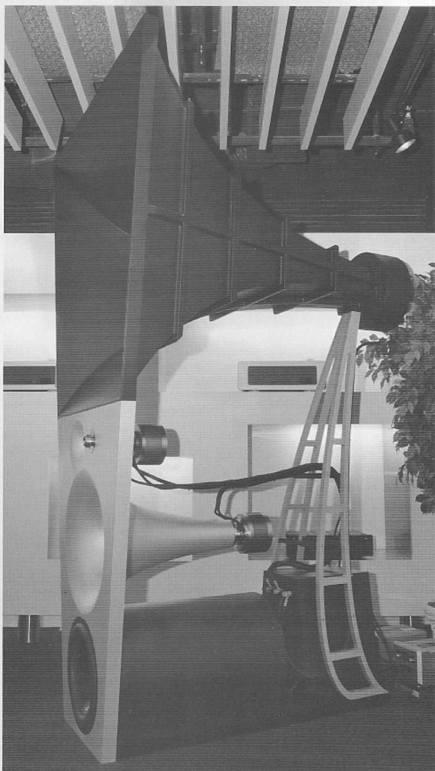
▲為配合100Hz以上的中低音波長，Alon Wolf說必須使用如此巨大的號角擴散器（上半截），才能取得全頻連貫一致的涵接。
