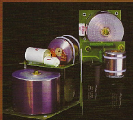
MAGICO的分音器都委由德国科隆的发烧音响组件名厂Raimund Mundorf公司制作，使用该公司生产的铜箔电感、MCap、MCap-Supreme、MCap-Supreme金银电容等非常昂贵的零件，连电路板的铜箔都以高纯度无氧铜材料制作。
