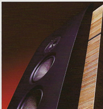
MAGICO特别喜欢用铝金属来制造音箱, M5的前障板也是用整块200磅重的6061-T6航空铝板以5向CNC方式车制而成。
