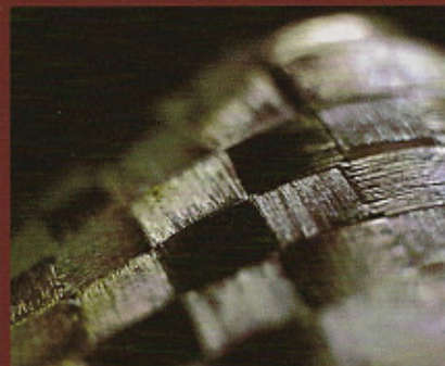
M5的2只中音和两只低音单元都采用了新开发的Nano-Tec碳纤维编织振膜单元，它是全球第一个采用Elliptical Symmetry Crossover（椭圆型对称架构）结构的喇叭单元，能实现音盘的整体力学分布更理想，达到更好的声音准确性。
