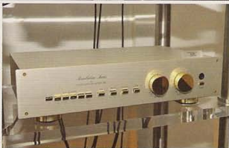
前级：FM Acoustic Resolution系列FM 266-MKII晶体管前级(用植入式电源线供电)
